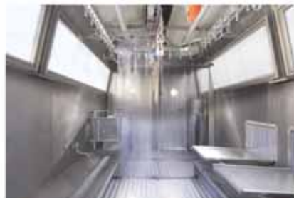
Внутренний вид стандартной бойни для свиней и птицы с разделением на грязную и чистую зоны
